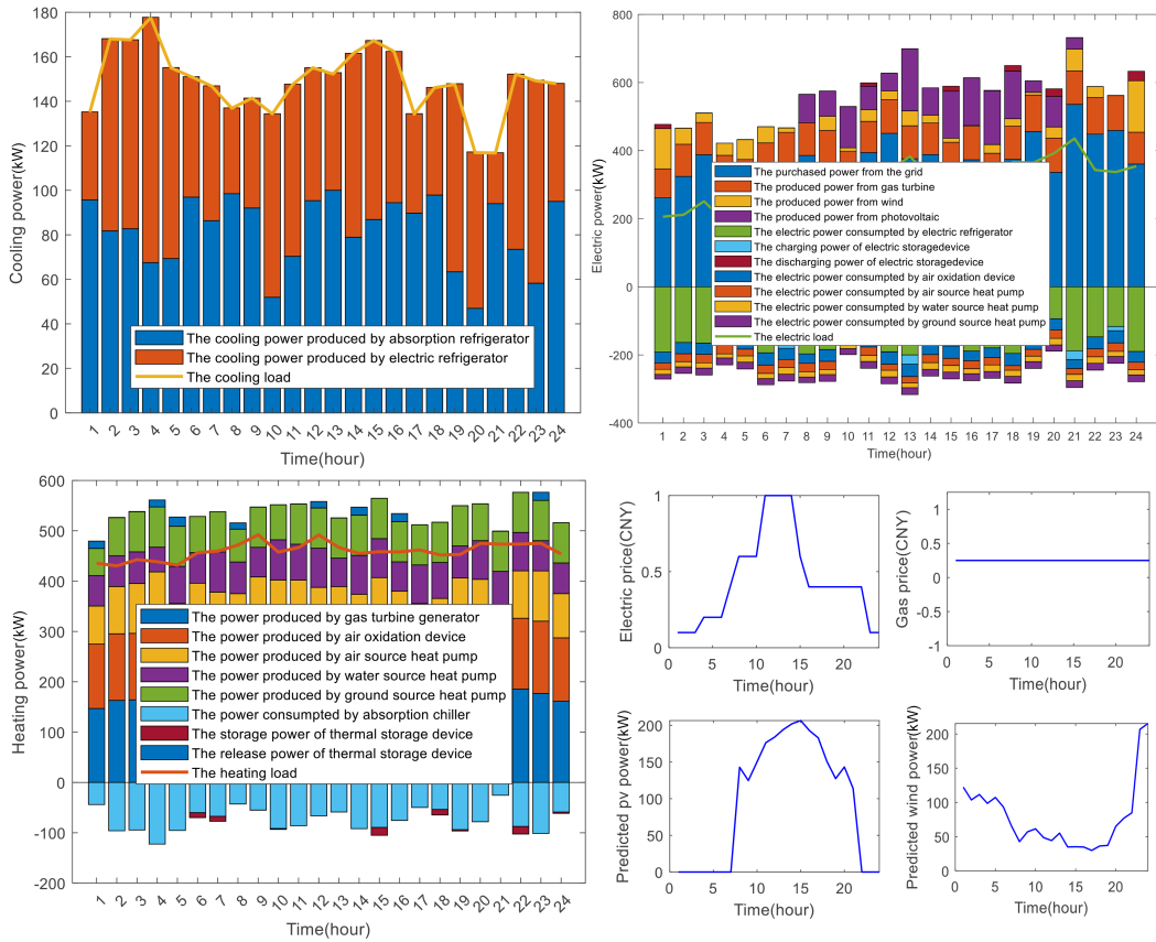
图 1 (网络版彩图) 解方案中对设备出力的调度情况以及优化模型中的关键参数
