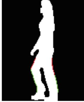
图 1 (网络版彩图) 选取轮廓边界用于回归腿部倾斜角度. 图中红色的轮廓是大腿轮廓, 绿色的轮廓是小腿轮廓
